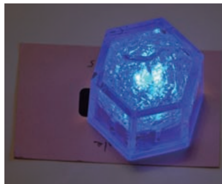
図 12 クリスタルキャンドルによるポリピロール薄膜の導電性確認
