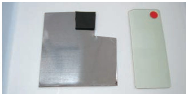
図13-1 ITOガラスの導電面の確認
