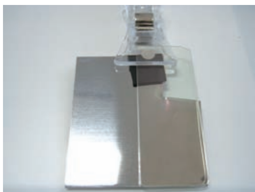
図13-2 ITOガラスとステンレス板の固定
