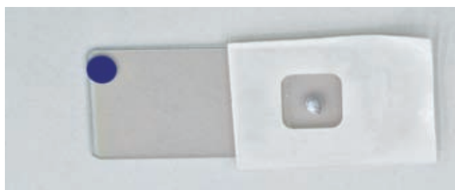
図15-2 Ga・In 共晶混合物(電子注入層)の準備
