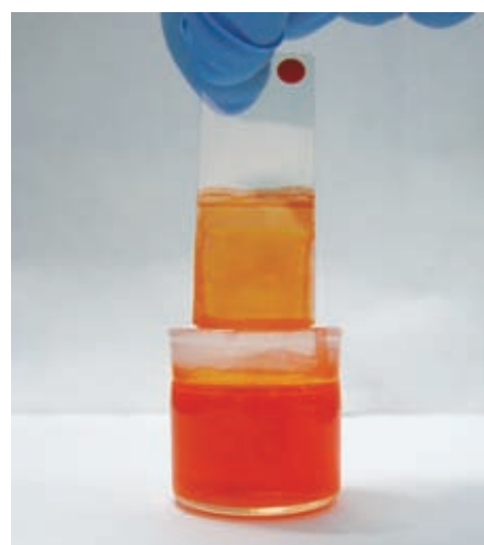
図14 MEH-PPV(発光層)のディップコート
