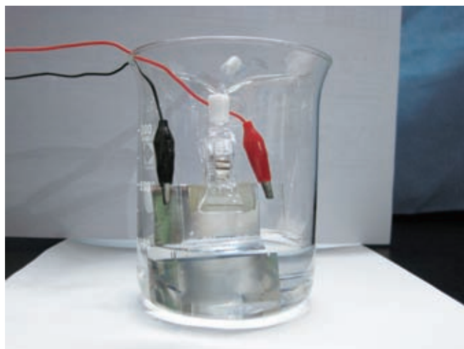
図10 電気化学重合によるポリピロールの合成
