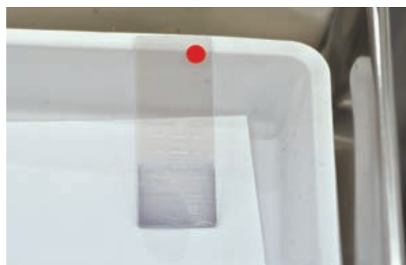
図13-5 PEDOT薄膜(ホール注入層)の乾燥
