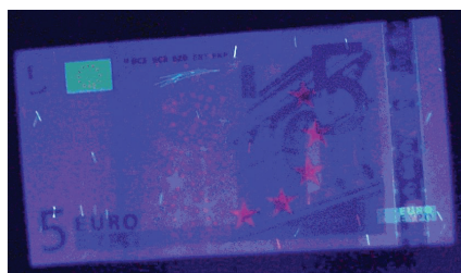
図3 (上図)青色( \text{Eu}^{2+} )、緑色( \text{Tb}^{3+} )、赤色( \text{Eu}^{3+} )の(小型)蛍光灯用蛍光体の254 nmのUV照射下における発光の様子。白色の発光は、青色、緑色、赤色の蛍光体を混合することによって得られます。(下図)360 nmのUV照射下におけるユーロ紙幣。星や繊維からの赤色、緑色、青色の発光は、 \text{Eu}^{2+} (青色と緑色)および \text{Eu}^{3+} (赤色)に由来するものです。
