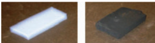
図1. 未ドーピング（左）および炭素ドーピング（右）の超低密度 \text{SiO}_2 網目構造材料の外観
