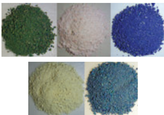
図4. 粉末状3DOMジルコニア、シリカ(上中)、チタニア(下左)の写真。3DOMジルコニアサンプルの色調の違いは細孔径の違いによるものです。
