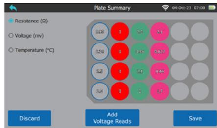
Millicell® Cloud にデータを保存する前に、電圧または抵抗モードを選択し、実験測定を表示し、ウェルを保存、削除、再読み込みをします。
