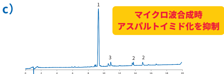
図：a) Fmoc-Asp(OtBu)-OH を使用、c) Fmoc-Asp(OEpe)-OH を使用し合成した H-Val-Lys-Asp-Arg-Tyr-Ile-OH における 20% ピペリジン DMF 溶液にて 60°C、200 分処理後の HPLC チャート比較 ピーク番号：1) 目的ペプチド, 2) ピペリジド類, 3) アスパルトイミド
