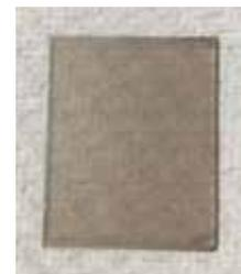
図23 ミストデポジション法により成膜したハロゲン化鉛メチルアンモニウム
