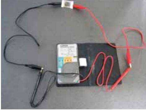
図19-1 ペロブスカイト太陽電池とリード線の接続
