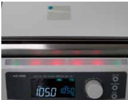
図12-3 酸化チタン層の乾燥
