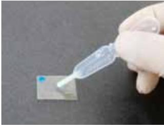
図12-1 酸化チタン溶液の滴下
