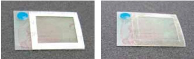
図17-1 導電フィルムへの両面テープの貼りつけ
