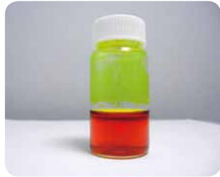
図3. LC/MS/MS分析用ウコン抽出液(167倍希釈);未処理、処理後の比較
