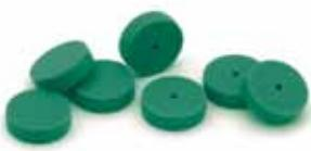
サーモグリーンLB-2セプタム(モールドタイプ)は、独自のLB-2ゴムで製造されており、この材料は、クロマトグラフィーに用いられている高品質の低ブリード材料です。モールドタイプのセプタムは、これまでの打ち抜き型のセプタムと異なり装着が簡単で、よりよいシーリングが得られます。これは、液状樹脂射出成形プロセスを採用することで、揃った形状のシャープでクリーンな側面が得られるためです。
