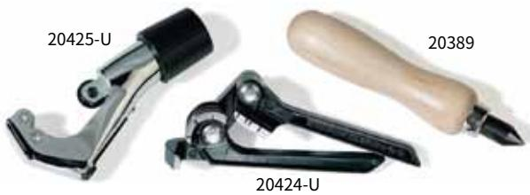
最高のクロマトグラフィー性能を得るには、適切なガスライン接続が重要です。チューブと接合部との接続不良で漏れが起きると、GCカラムに大きなダメージを与えることがあります。チューブ末端はきれいにカットしておくことが極めて重要です。
