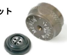
Merlin社製マイクロシールシステムは、セプタムの寿命を延ばすために2種のシールを一連にした独自の構造をしています。この特許登録済みの構造は、キャビラリーインレットシステムの標準的なセプタムとセプタムナットの代替となります。需要の多いキットを以下に示します。
