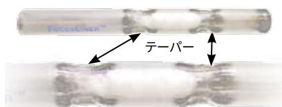
ウールプラグは長年にわたり使用されており、サンプルをすばやく完全に蒸発させ、質量分別を最小に抑え、不揮発成分がカラムに入るのを防ぎます。FocusLinerインレットライナーは、ウールプラグが注入の繰り返しや急な注入圧力の変化によって移動しない独自の構造をしています。高需要のFocusLinerインレットライナーを以下に示します。他のインレットライナーは弊社ウェブサイト(英語)をご参照ください。[sigma-aldrich.com/gc](http://sigma-aldrich.com/gc)
