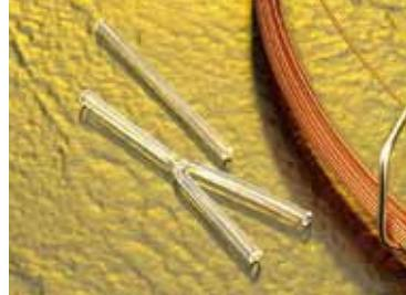
ガードカラムを分析カラムに付けるため、または破損したカラムの修理にGlasSealコネクターを使用します。
