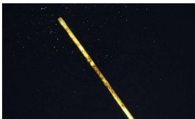
図5. 表面保護処理したSPMEファイバーで裏ごしブルーベリーフード試料の抽出を繰り返した後の写真
