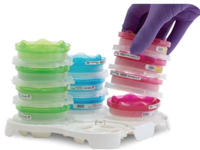
**連結してロックできる構造：**プレート同士を連結してロックできるため、安全に運搬できます。また、空のファネルトレイはインキュベーションラックとしても使用可能です。
