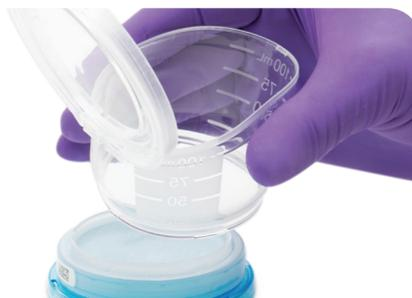
**ファネルの取外しが容易：**少しまむだけで簡単にファネルをメンブレンから外せます。また、プラスチックを折るような力の要る操作は一切ありません。ファネルのフタは培地カセットのフタとしてその後のインキュベーションに使用します。
