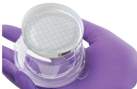
**タッチフリーでメンブレンを培地へと無駄なく移動可能：**タッチフリー用のシールされたメンブレンは、誰が作業しても気泡が生じたりフィルタが折れ曲がったりしないよう、ろ過後は凸型に膨らんでいます。
