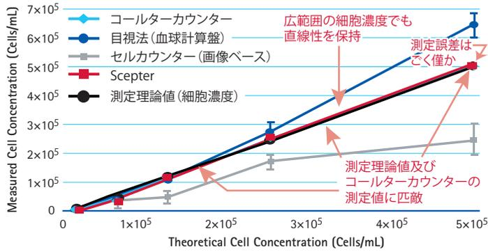
Cos7 細胞を使用し、60  $\mu\text{m}$  のセンサーチップで 4 回測定した結果を示します。測定理論値に対し、コールター原理を用いた Scepter はコールターカウンターと同様に高い直線性を示しました。このことより、Scepter はいずれの細胞濃度においても、安定した測定値と高い再現性が確認されました。
