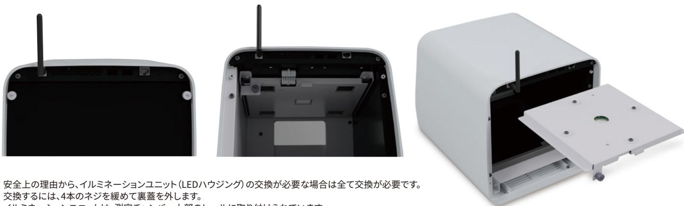
安全上の理由から、イルミネーションユニット (LEDハウジング) の交換が必要な場合は全て交換が必要です。交換するには、4本のネジを緩めて裏蓋を外します。イルミネーションユニットは、測定チャンバー上部のレールに取り付けられています。
